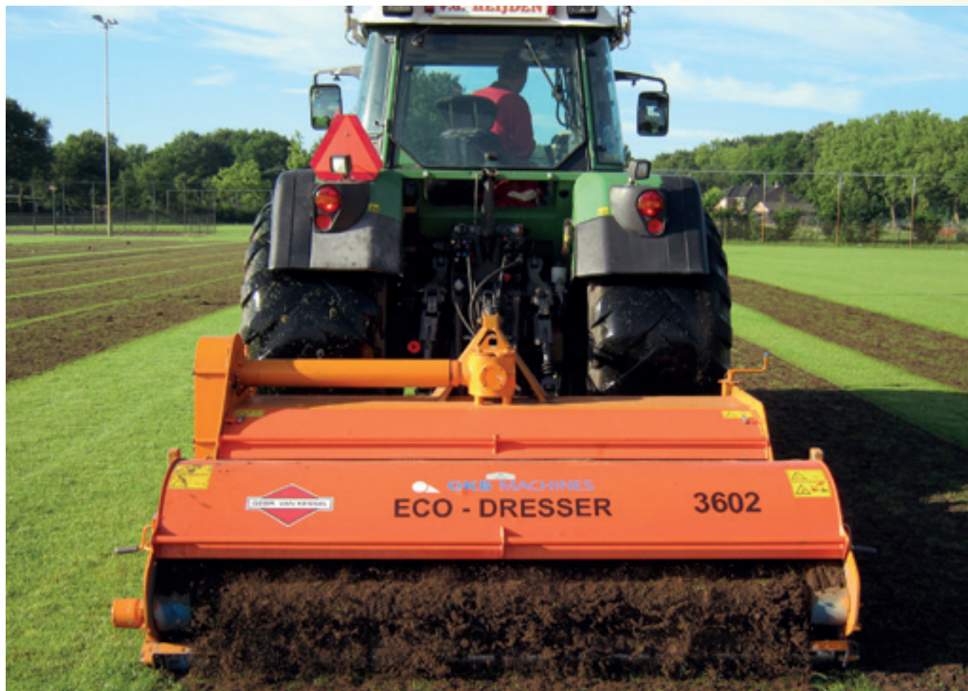
De recyclingdresser in actie: door gebruik te maken van grond uit het bestaande veld wordt voorkomen dat vreemde grond aangevoerd moet gaan worden, met het risico op onkruidzaden. Daarnaast is het ook een vorm van beluchten, gunstig voor het bodemleven.
